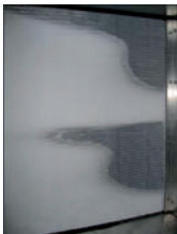
Figuur 9: dichtvriezen van een microchannel verdamper.
