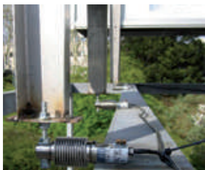
figuur 1 Krachtopnemers geplaatst onder de condensor.
