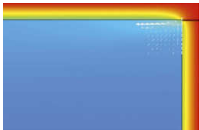
Figuur 5: Instroom van leklucht. De geïsoleerde wanden laten een warmtestroom door van ongeveer 6W/m 2 .
