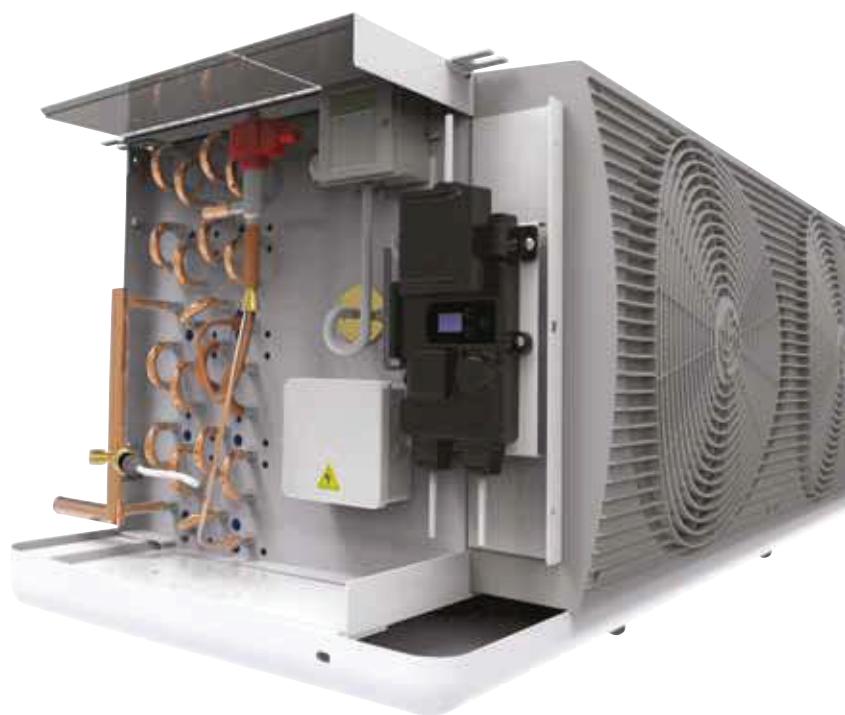
De Nidea (zwart) gemonteerd op een luchtkoeler zorgt voor optimale ontdooiing. Het elektronisch expansieventiel is het rode element. Op de foto ontbreekt de bedrading.
