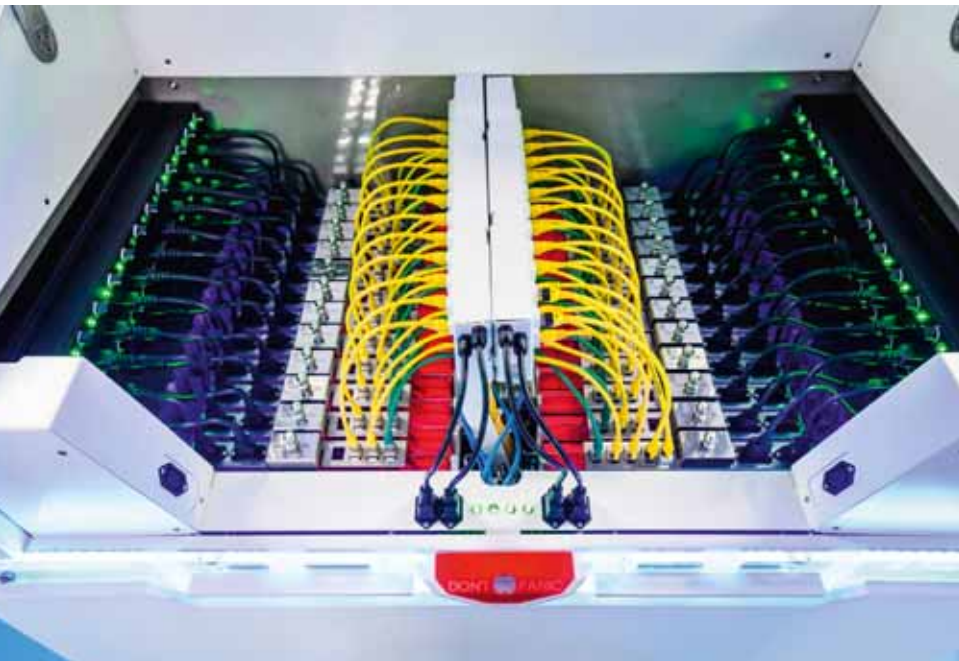
Bovenaanzicht van de unit, met de bovenzijde van de cassettes met hardware die in de olie hangen.
