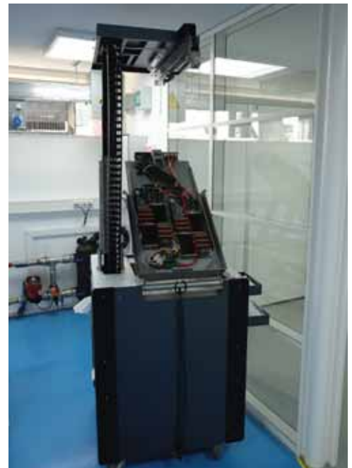
De onderhoudstrolley met het liftstelsel waarmee de cassettes uit de olie worden getakeld.
